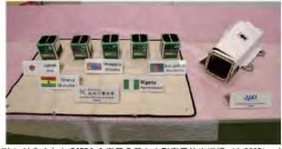
JAXA に納入された BIRDS-I 衛星 5 基と小型衛星放出機構 (J-SSOD) © JAXA
